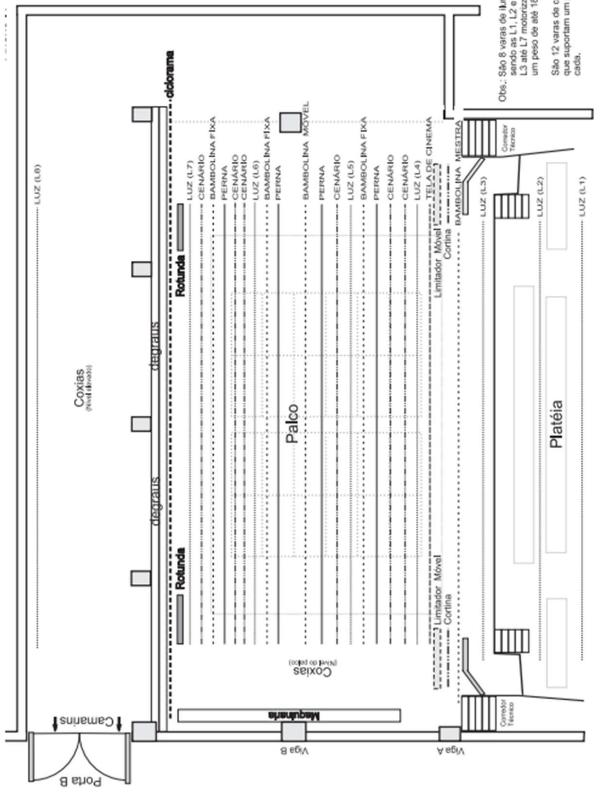
Obs.: São 8 varas de iluminação cênica, sendo as L1, L2 e L8 fixas e as L3 até L7 motorizadas, que suportam um peso de até 180kg cada.
